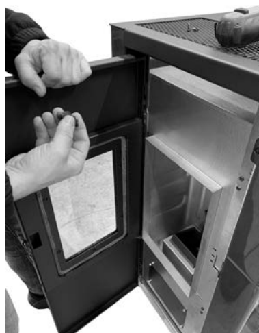
Fig. 19 - Αφαιρέστε το μεντεσέ
