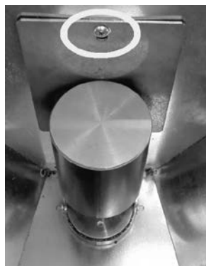
Fig. 38 - Αφαιρέστε τη βίδα
