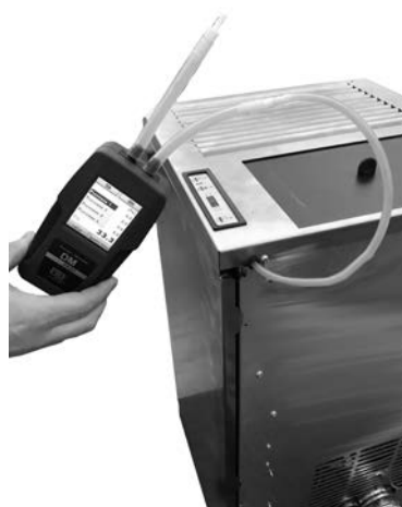
Fig. 27 - Σύνδεση ψηφιακού πρεσοστάτη
