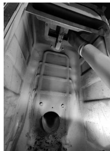
Fig. 34 - Κάντε αναρρόφηση της τέφρας
