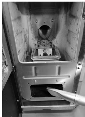
Fig. 32 - Κάντε αναρρόφηση της τέφρας
